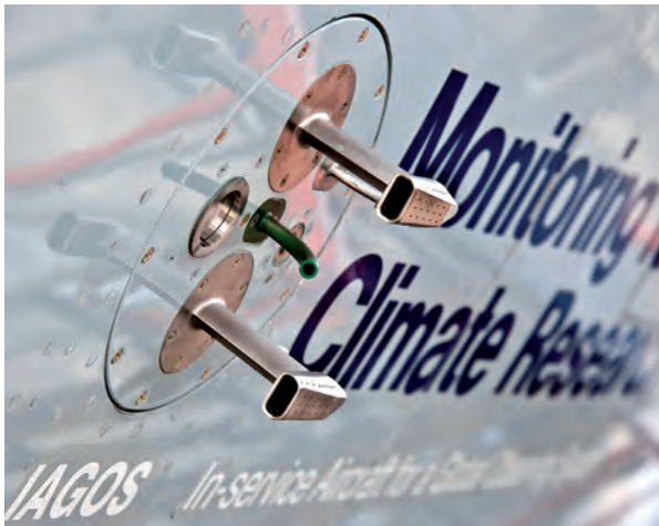
Einlassplatte am Lufthansa-Flugzeug für Messgeräte
